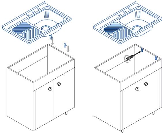
2. Incline el lavatrastos para enganchar la ceja con el ancla como aparece en el dibujo y gírelo hacia abajo hasta quedar completamente sobre el mueble.
