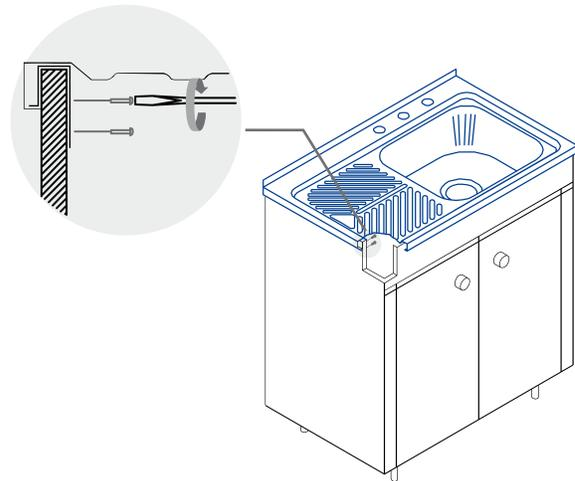
5. Después deberá colocar la contracanasta o desagüe y la llave mezcladora, asegurándose de apretar lo suficiente, una vez llegadas las tuercas al tope y su fregadero EB quedará listo para servirle ¡toda la vida útil que usted le permita!
