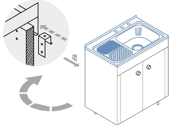
4. Por el interior del mueble, deslice los clips hasta los puntos indicados y atornille.
