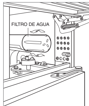
Extracción del filtro de agua
