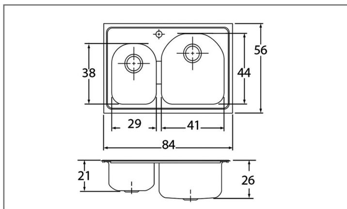
Modelo del diagrama: ECG-332210L
